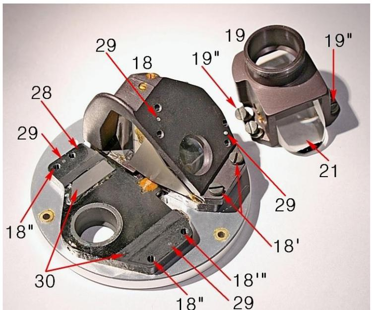
Fig. 35m – Ecco il supporto del prisma di Schmidt sinistro. Si notino le due piastrine 32 e 33 che determinano lo spazio esatto riservato al prisma fra il supporto 18 e la piastra di base 28 della figura precedente.
