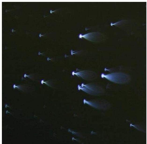
Come prima osservazione, si constata che il difetto (la coda delle centriche) è orientato in maniera speculare nei due canali: effetto ovvio se il difetto non è limitato ad uno dei canali, dato che l'inclinazione del raggio principale dei due canali, nello spazio fra obiettivo ed oggetto, è la stessa rispetto al piano mediano dello strumento.
