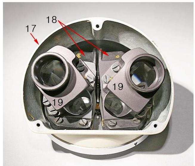
Fig. 35h (a destra) – Dopo aver smontato le tre viti 15 della fig. 35f (pag. 1328) ed il guscio 17, si accede liberamente al gruppo dei prismi, con i supporti 18 e 19 già visti.
