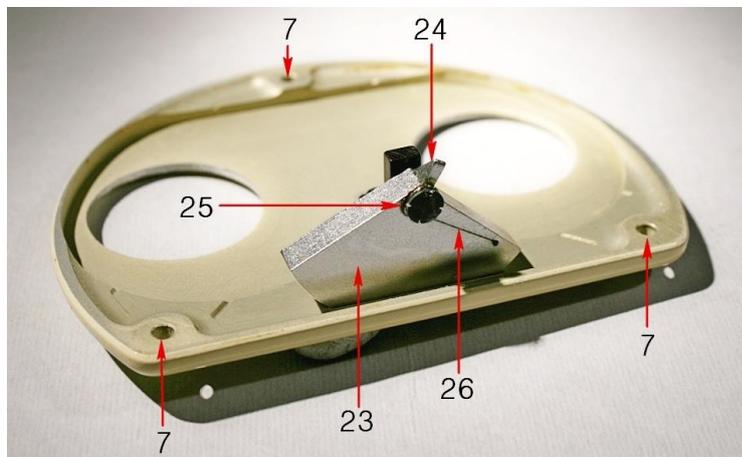
Fig. 35k (a sinistra) – Sul rovescio del coperchio del tubo si vede il settore circolare 23, capace di ruotare attorno al perno 25 e spinto a ruotare in senso orario dalla molla 26.
